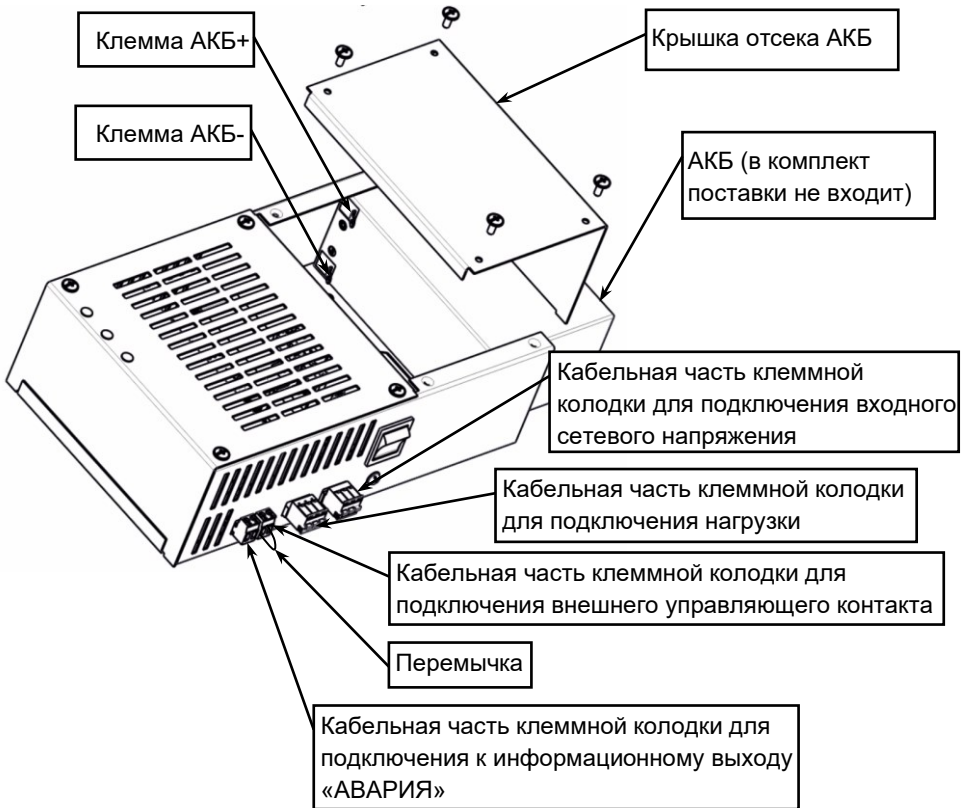
Рисунок 3 — расположение АКБ и кабельных частей колодок
